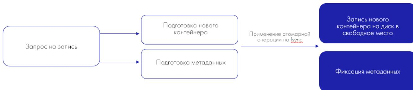
Рисунок 15 - Копирование при записи
